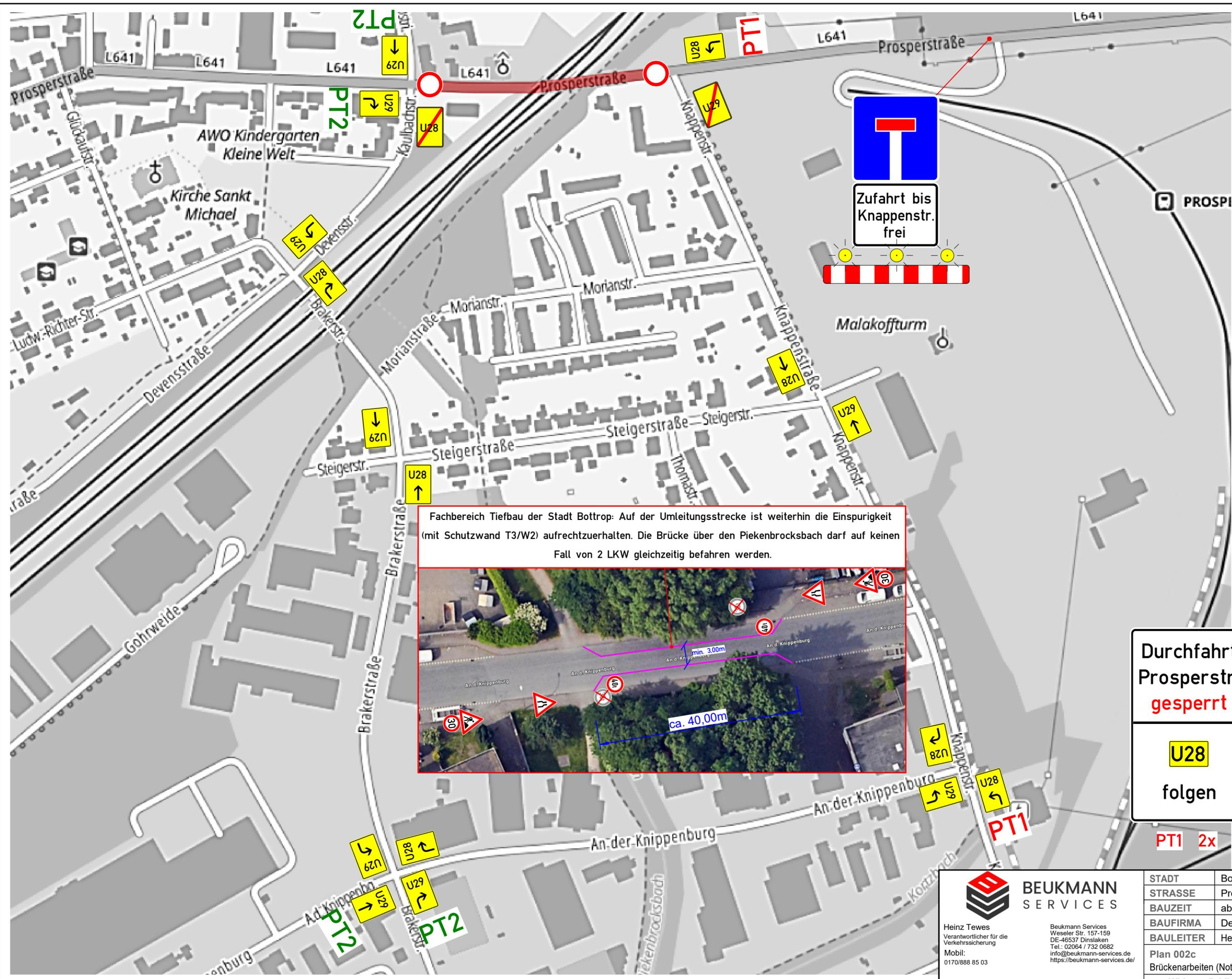
Fachbereich Tiefbau der Stadt Bottrop: Auf der Umleitungsstrecke ist weiterhin die Einspurigkeit (mit Schutzwand T3/W2) aufrechtzuerhalten. Die Brücke über den Piekenbrocksbach darf auf keinen Fall von 2 LKW gleichzeitig befahren werden.
